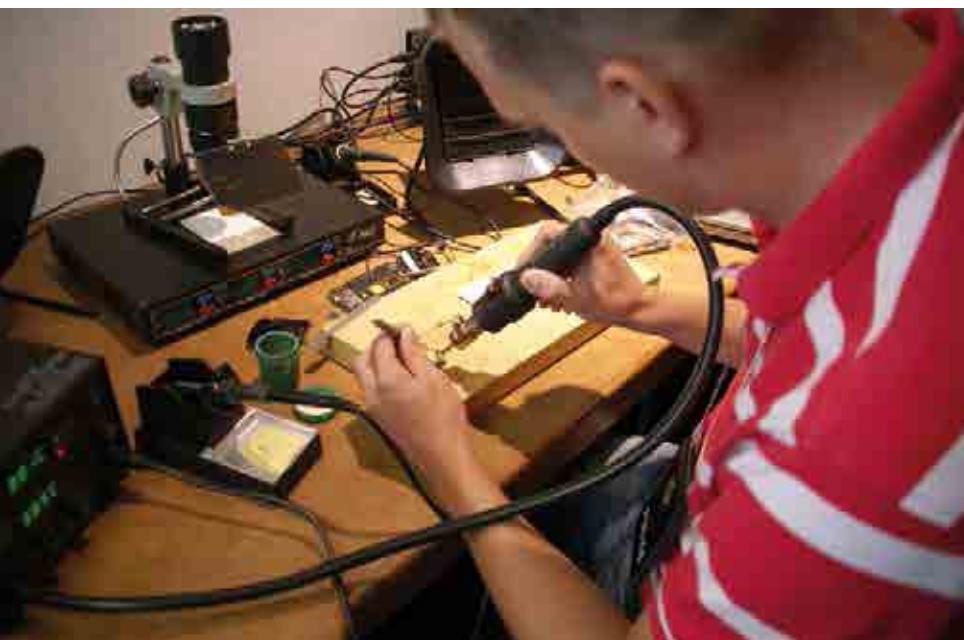
Digitaal expert Matthijs is bezig met de chip-off van een smartphone.
